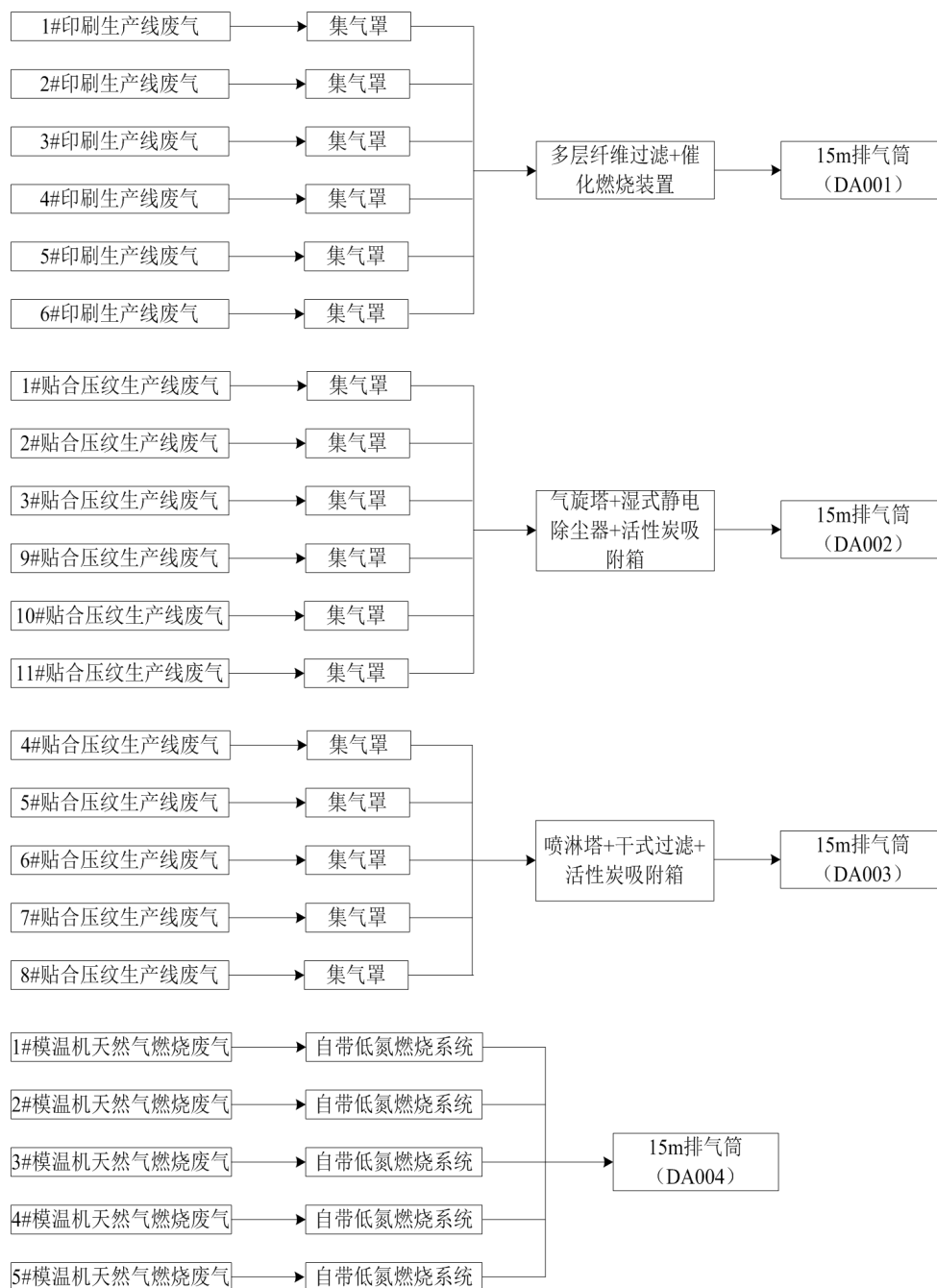
图 4-1 项目有组织废气收集及治理流程图
