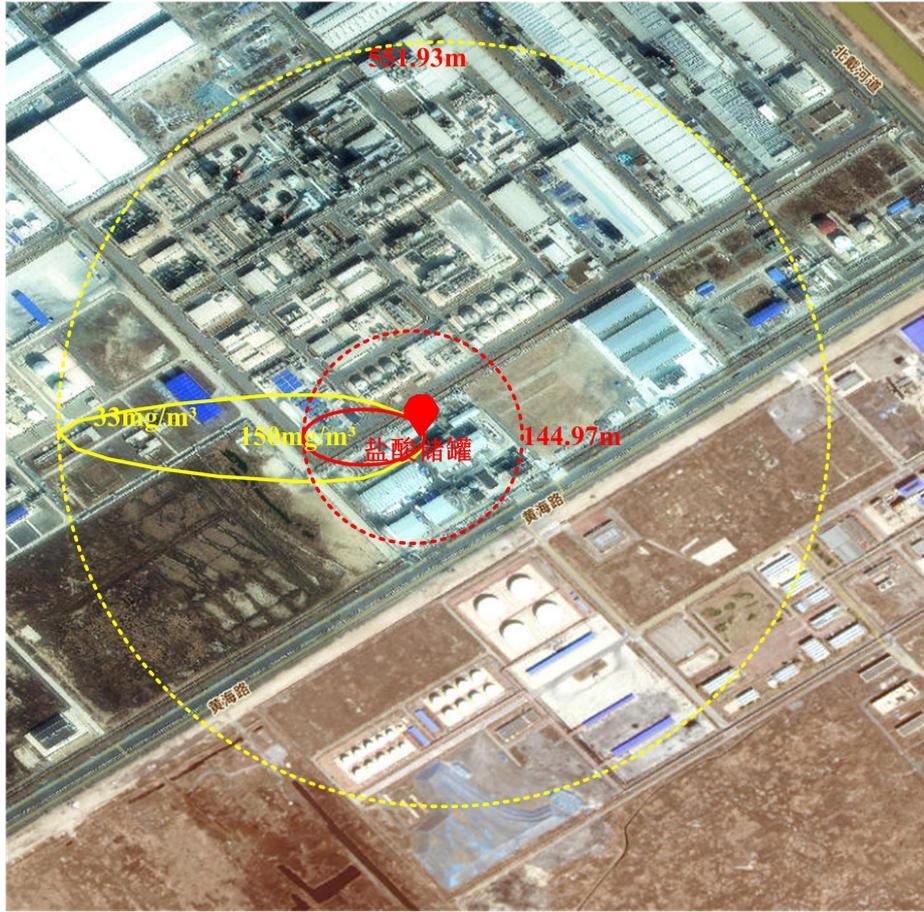
图 3.5-1 盐酸储罐泄漏最大浓度分布图（最不利气象条件下）
