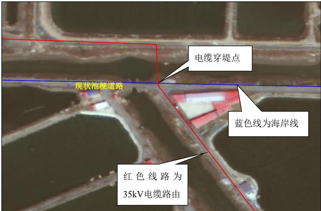
图2.4-4 (b) 本项目电缆与海岸线关系图 (放大)
